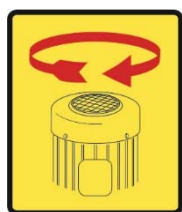
Il. 4: Przykłady: strzałka na pokrywie silnika prawoobrotowego
