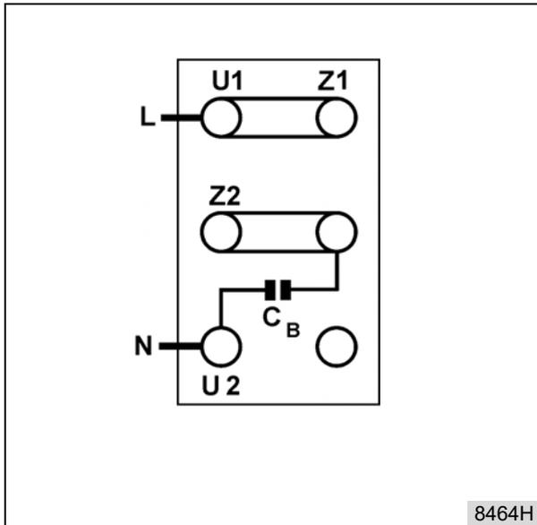
Abb. 30: Prinzipschaltbild für 230 V für 1 ~ Wechselstrom
