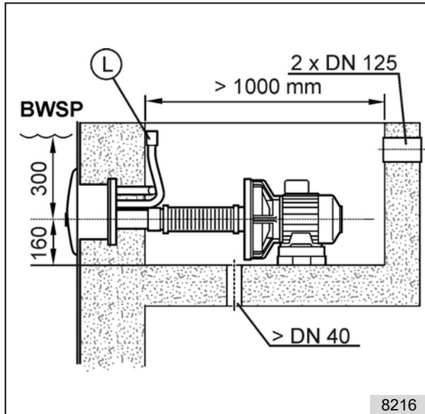
Abb. 9: Schnitt durch den Pumpenschacht
