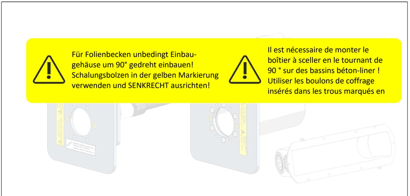
Fig. 4 Remarque condition de montage bassin béton avec étanchéification au liner
