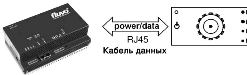
Контроллер **i-light touch** может работать после его подключения имеющимся в продаже стандартным кабелем данных **RJ45** к соответствующему гнезду блока управления **RGB Luchs NT**.
