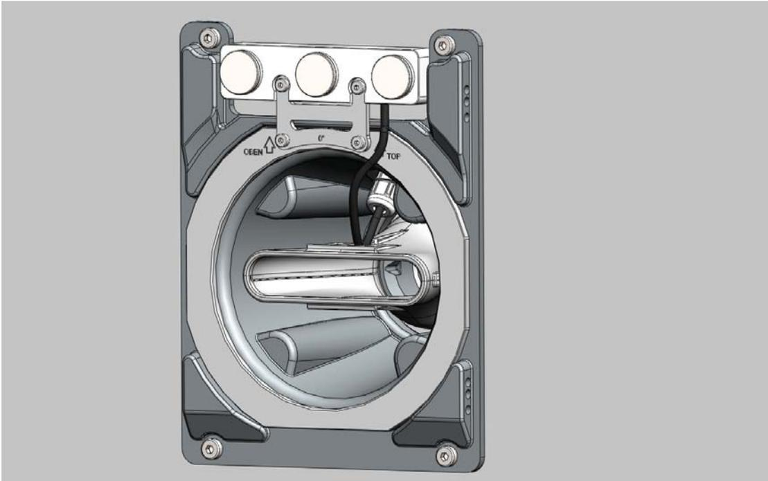
Conduire le câble de l'unité de commande à travers le raccord de câble à vis et la couverture de protection de câble jusqu'à un répartiteur approprié ou directement jusqu'au convertisseur de fréquences. Fermer ensuite le raccord de câble à vis de manière étanche.
